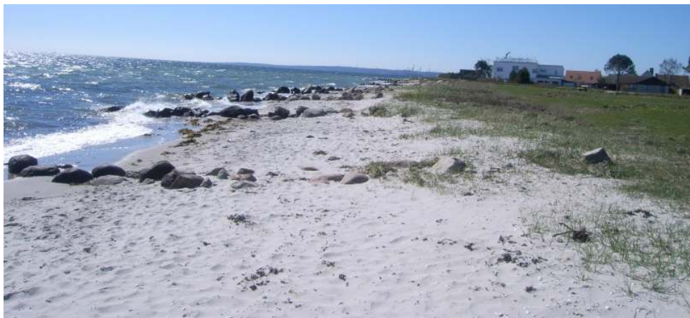
Figur 3-30 Strand med små uhensigtsmæssige (ud fra et sikkerhedsmæssigt synspunkt) stenhøfder ved den nye surfstrand ved iskiosken
