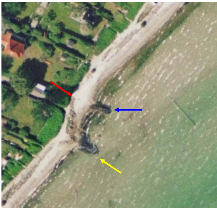
Figur 4-1 Høfde ved Platanvej (gul pil), erosion af diget (rød pil) og udløbsledning (blå pil).
