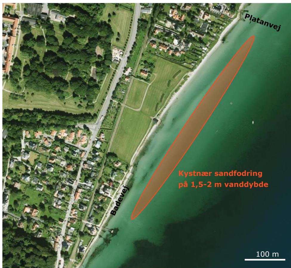
Figur 5 Placering af fint sand fra Egå Marina som kystnær sandfodring udfor kysten imellem Badevej og Platanvej.
