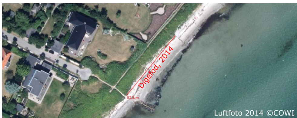
Foto 3 Kysten lige nord for Rønnevej (set mod syd) med læsideerosion i digefoden som konsekvens af forstærket stensætning omkring udløbsledning i 2015.
