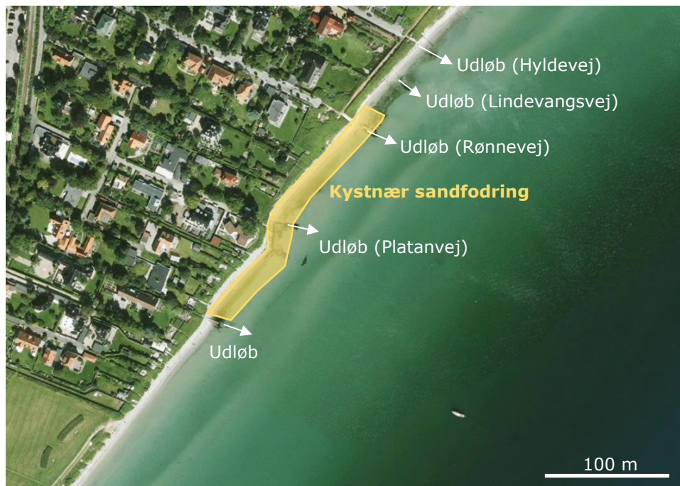
Figur 4 Placering af fint sand fra Egå Marina som strandfodring langs stranden omkring Platanvej.
