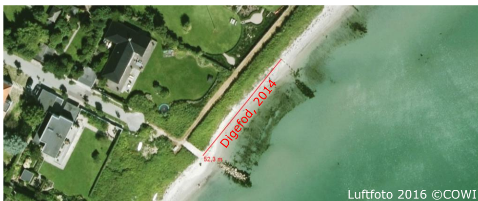
Figur 1 Sammenligning af luftfotos fra 2014 og 2016 der viser erosion i digefod som følge af forstærket stensætning omkring udløbsledning i 2015. Luftfotos ©COWI.
